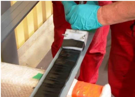
Abbildung 15: Beispieldarstellung Nutzung Breitschlitzdüse zum Klebstoffaustrag
