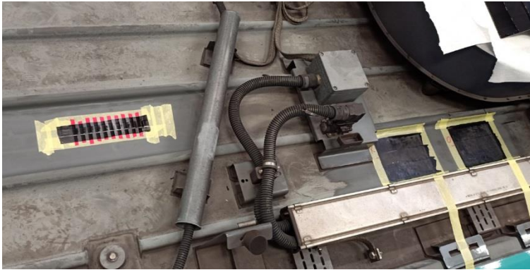
Abbildung 23: Anordnung der geprimerten Klebfläche auf dem Dach (Beispielbild aus Projekt U5)
