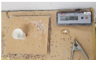
Abbildung 8: Bedarfsmenge Harz einwiegen & Härter nach MV dazu dosieren
