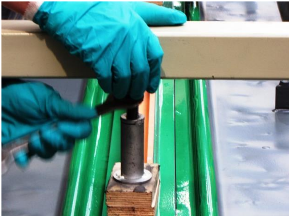
Abbildung 18: Beispieldarstellung Nutzung Gewindespreizer
