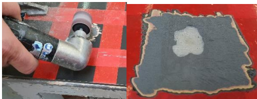
Abbildung 4: Schadbereich konkav geschliffen/ ausgearbeitet
