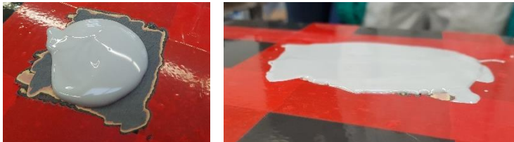
Abbildung 10: Topcoat leicht verstreichen - auf Überstand (Wölbung nach oben) achten
