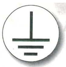
Abbildung 3-2 Kennzeichnung der Erdungssammelschienen (nicht maßstäbliches Muster)
